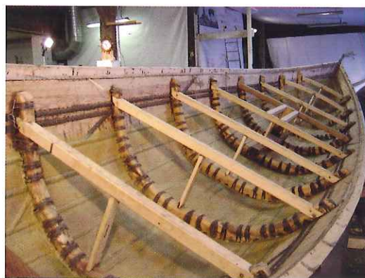
Les membrures et le bordé assemblés par ligatures du Gyptis (Photo : Eric Rieth, CNRS)
